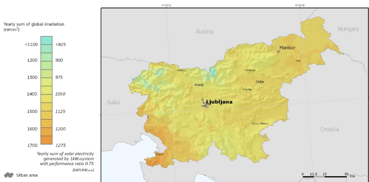
Slika 6: Sončna obsevanost v Sloveniji glede na optimalno postavitev PV modulov
